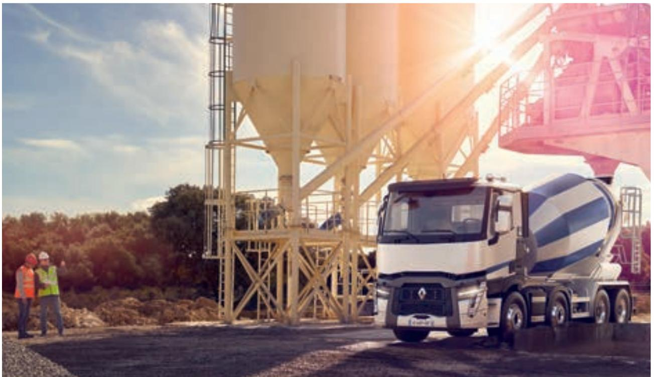
Der C XLOAD Mischer mit 8x4 Starrachse und einem Leergewicht von 9200 kg.
