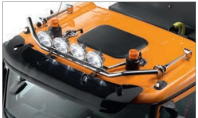
Lampenbügel mit LED-Zusatzscheinwerfern
